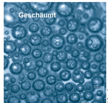
Bild 3 > Ungeschäumtes und geschäumtes Vestoplast unter 125facher Vergrößerung – ohne Stickstoffzugabe (links), mit einem Stickstoffgehalt von 65 % (rechts)
