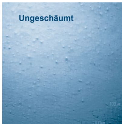
Bild 3 > Ungeschäumtes und geschäumtes Vestoplast unter 125facher Vergrößerung – ohne Stickstoffzugabe (links), mit einem Stickstoffgehalt von 65 % (rechts)
